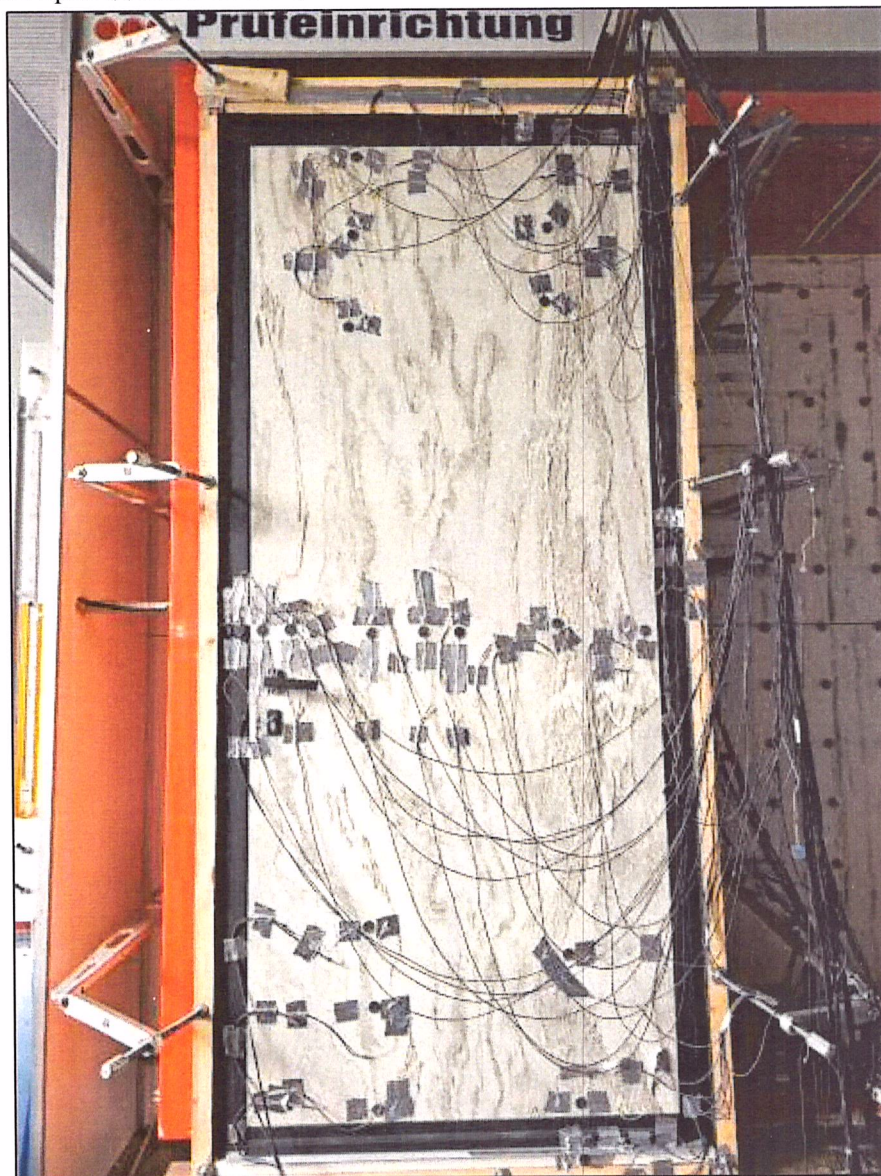
Рисунок 4.1 – Схема расстановки датчиков температуры и плотности теплового потока на испытываемом образце 453-24/2
